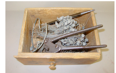
Plombiergerät - nach der Restaurierung
