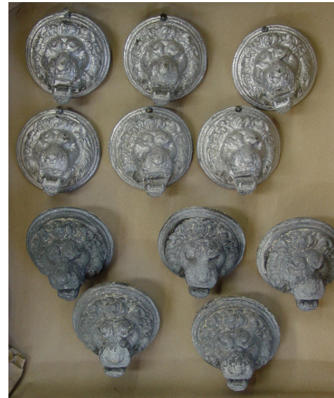
Löwenköpfe - oben Aluminium, unten Bleilegierung - nach Abnahme der Farbauflagen
