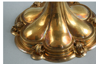
Irisierende Anlaufschichten am Fuß
